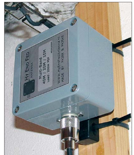
Bild 3: An der Mauer im Dachboden befestigtes Unun-Gehäuse Fotos: DL6RAL
