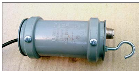
Bild 3: Gleichtaktdrossel im montierten Zustand mit Blechtreiberschrauben
