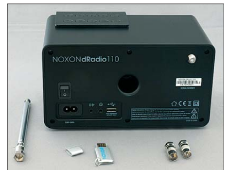
Bild 2: Rückseite des Noxon dRadio 110 mit Antenne, USB-Stift und Adaptern für Außenantennen Fotos: DL2MCD
