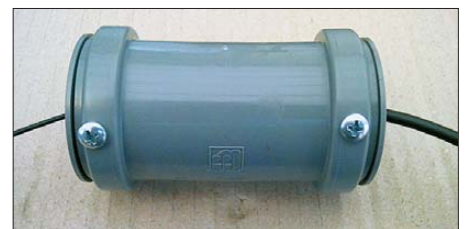
Bild 5: In einer HT-Rohrmuffe montierter Breitbandübertrager Fotos: DF10G
