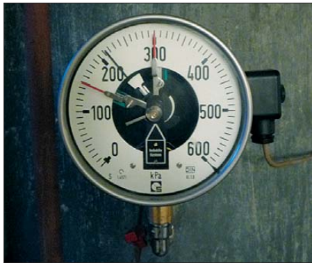
Bild 1: Kontaktmanometer mit den beiden auf beliebige Werte einstellbaren Schaltkontakten Foto: DM4TR
