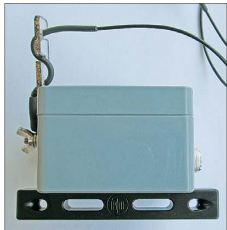
Bild 1: Unun-Kästchen; links Antennenanschluss mit Zugentlastung, unten Fritzel-Antennenisolator für die Befestigung, rechts Anschluss für das Antennenkabel
