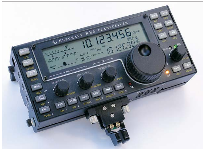
Bild 1: Der betriebsbereite KX3 mit CW-Paddel KXPD3, das sich ohne Werkzeuge anschrauben lässt. Bei Tageslicht kommt der KX3 dank reflektivem Display, wie hier zu sehen, sehr gut ohne seine (nicht in ihrer Intensität veränderliche) Hintergrundbeleuchtung aus, was etwa 20 mA spart.
