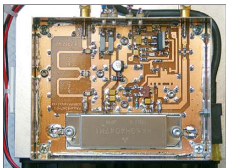
Bild 3: Das 60-W-Hybridmodul ermöglicht im Linearbetrieb etwa 40 W Ausgangsleistung bei einem IM3-Wert von 30 dBc.
