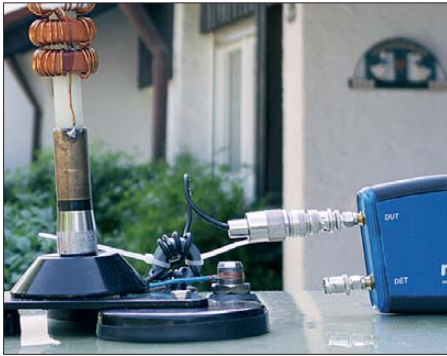
Bild 1: Messung an einer Eigenbau-Mobilantenne, die hier um den im Text beschriebenen 1:4-Transformator ergänzt ist
