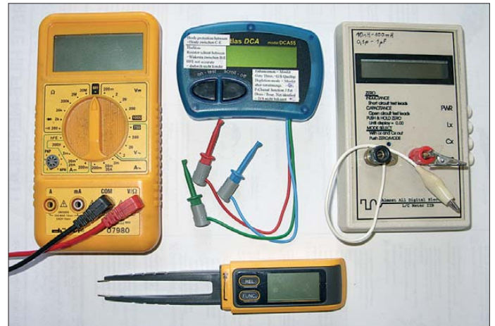
Bild 2: Ein kleiner Messgerätepark erleichtert das Basteln sehr. Ein Digitalmultimeter, ein oder zwei Bauteiltester und nicht zuletzt ein LC-Meter von AADE ermöglichen die sichere Unterscheidung der Bauteile.
