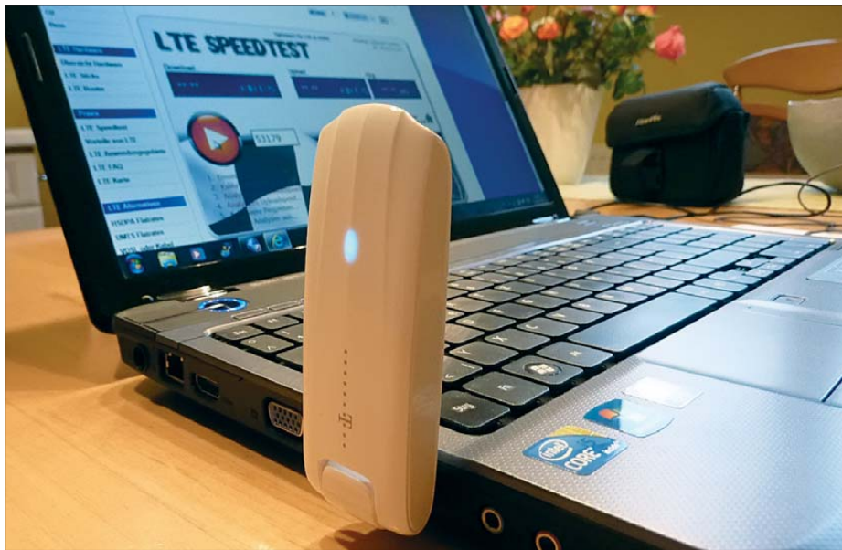
Bild 1: Notebook mit LTE/HSPA-Stick; dieser beherrscht HSPA auf 2,1 GHz mit maximal 42 MBit/s sowie LTE im Bereich 800, 1800 und 2600 MHz Foto: DK6ZD
